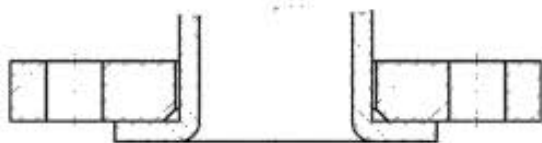
Тип 03 — Фланец стальной плоский свободный на отбортовке
